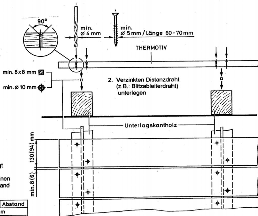
4. Verschrauben mit Edelstahlschrauben min.  $\varnothing$  5 mm, Länge 60 - 70 mm
